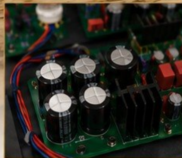
Fuente de alimentación con regulación y filtrado en múltiples etapas para una señal limpia y estable.
